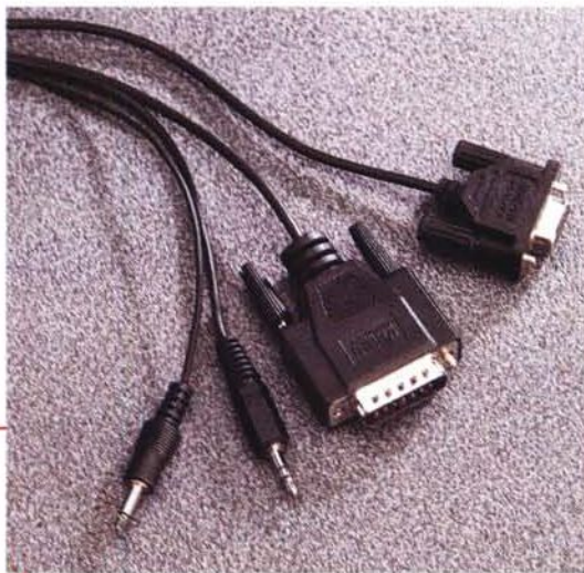
Le porte di connessione al computer: seriale, joystick, ingresso e uscita audio.
